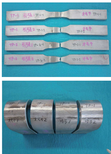
写真2 溶接施工法試験片
